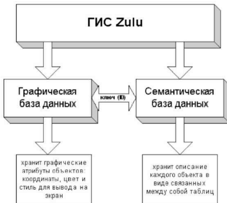
Рисунок 8.1. Структурная схема представления информации в системе Zulu
