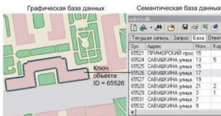
Рисунок 7.2. Пример взаимодействия семантической и графической баз данных
